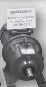
Привід для обертання каруселі екстрактора з обертовим моментом M_{кр} = 300000 \text{ Н} \cdot \text{м}
