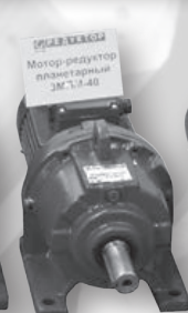
Привід для обертання каруселі екстрактора з обертовим моментом M_{кр} = 300000 \text{ Н} \cdot \text{м}
