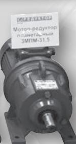
Привід для обертання каруселі екстрактора з обертовим моментом Мкр = 300000 Н · м
