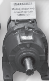
Привід для обертання каруселі екстрактора з обертовим моментом Мкр = 300000 Н · м
